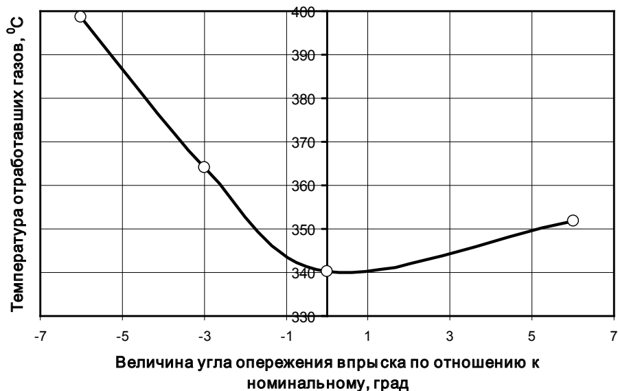
Рис. 4. Зависимость температуры ОГ от величины угла опережения впрыска топлива
