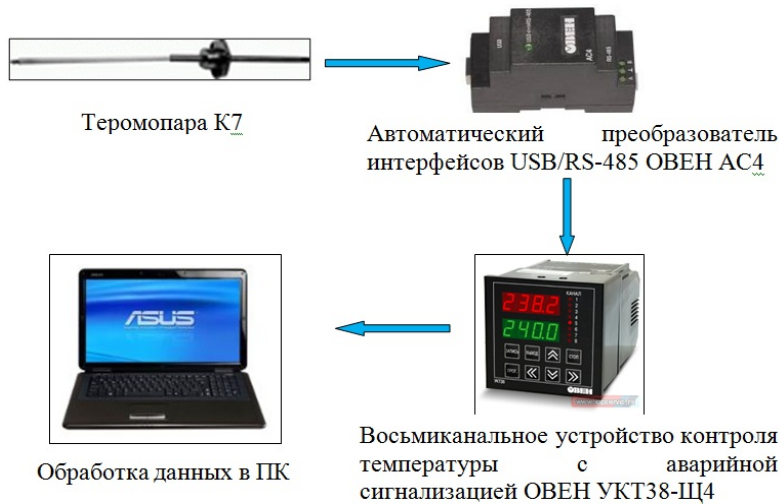
Рис. 1. Блок-схема экспериментальной установки
